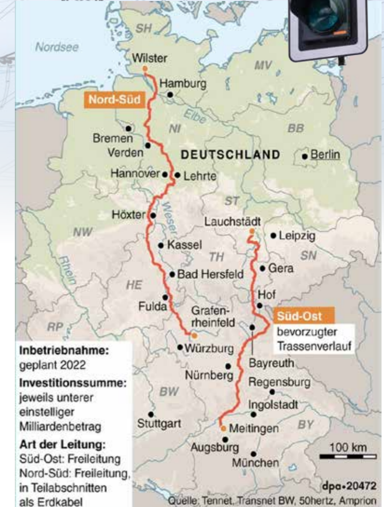
Die Karte zeigt zwei der geplanten Gleichstromtrassen. Nord-Süd soll u.a. die Offshore-Windparks in der Nordsee anbinden. Die Süd-Ost-Trasse bindet bestehende und geplante Braunkohlekraftwerke in Mitteldeutschland. Die dritte Trasse (nicht eingezeichnet) schafft eine Anbindung der Braunkohlereviere im Ruhrgebiet nach Süden.
